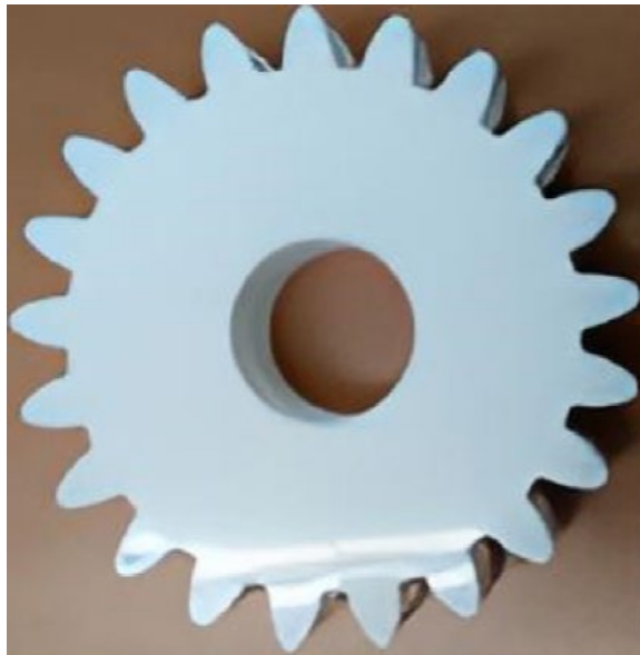
Exemple d'engranatge tipus A ( m = 3 mm, z = 21 ) imprès amb PLA
