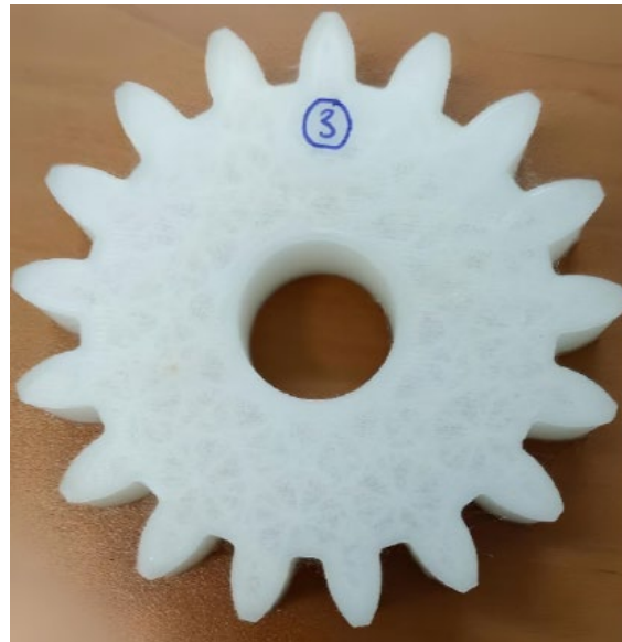
Exemple d'engranatge tipus B ( m = 4 mm, z = 17 ) imprès amb Nylon
