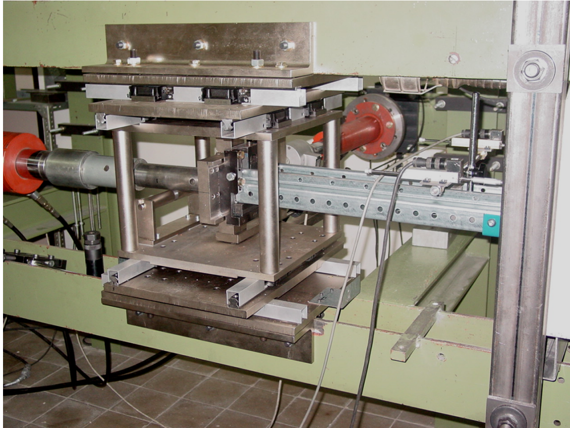
Assaig bi-axial de rigidesa de la unió puntal - terra
